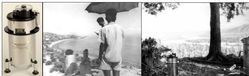
Fig. 13. Gravímetro geodésico Wörden e medições gravimétricas.
