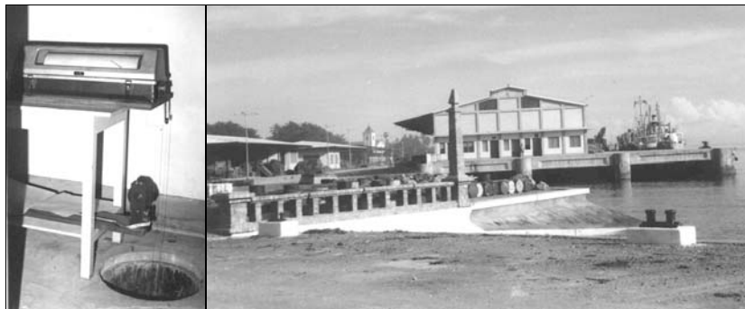
Fig. 12. Marégrafo e armazém em cujo interior está a sua casa abrigo.
