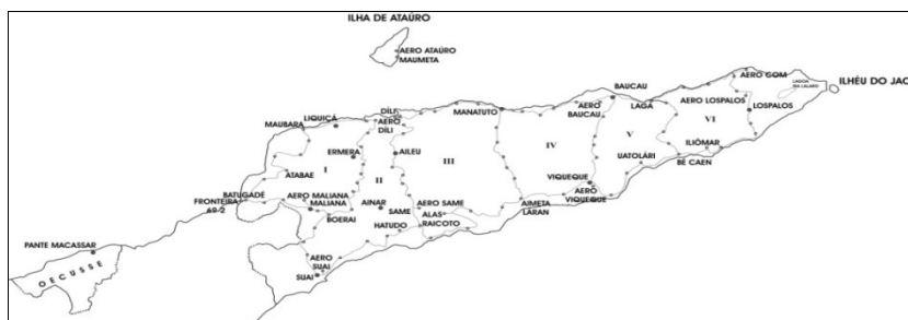
Fig. 10. Rede de nivelamento geométrico de Timor.
