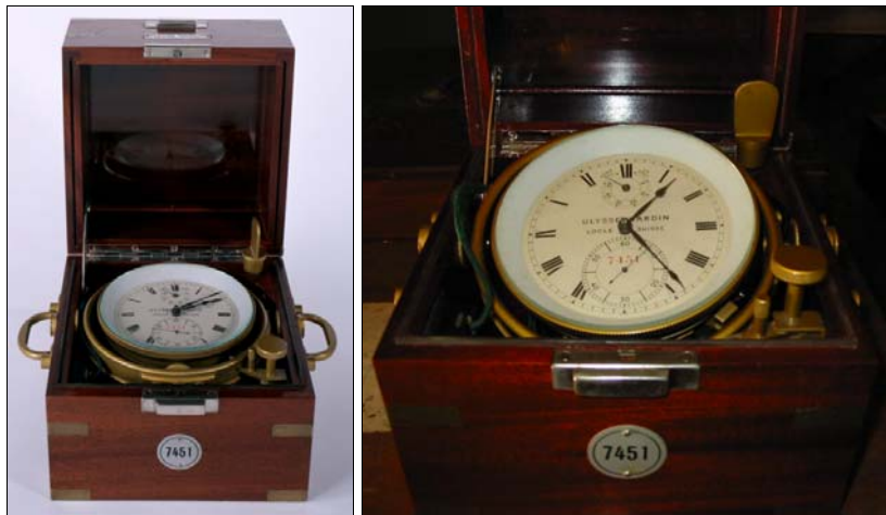
Fig. 9. Cronómetro sidereal Ulysse Nardin da MGT, instrumento usado na determinação do tempo durante as observações astronómicas
