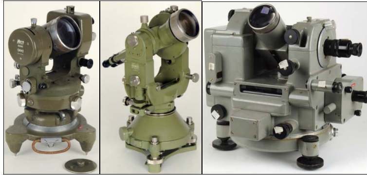
Fig. 6. Teodolitos Kern DKM3, Wild T3 e Askania-Gigas.
