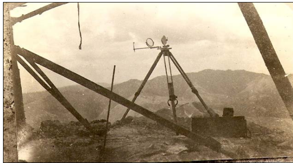
Fig. 7. Hélio instalado em Dia Tuto para reconhecimento da direção Dia Tuto – Luquene.
